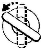
1. Když jsou všechny dveře zavřené, otočte klíč v zámku dveří řidiče do polohy „ODEMKNUTO“ a držte jej tak alespoň 5 sekund, až jednou zazní siréna alarmu.
