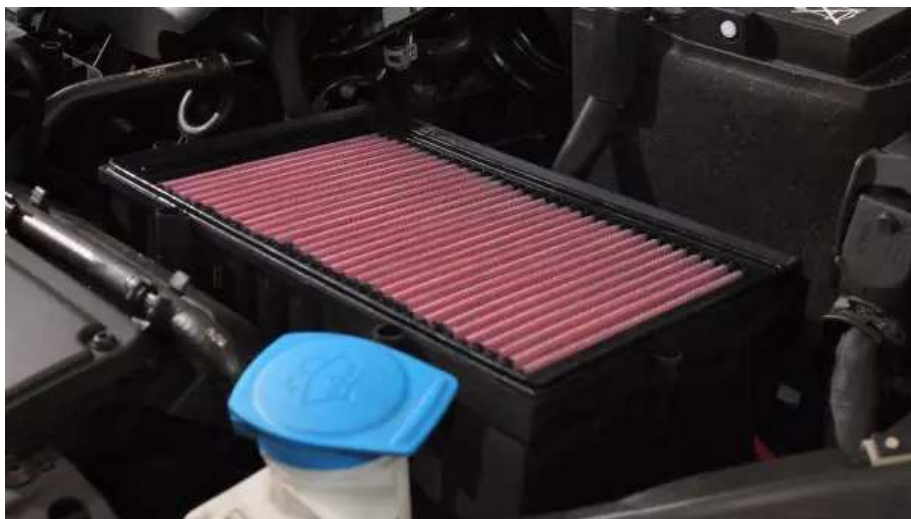
Sportovní vzduchový filtr od K&N je vyroben z bavlněné tkaniny napuštěné olejem © ADAC/Test und Technik
